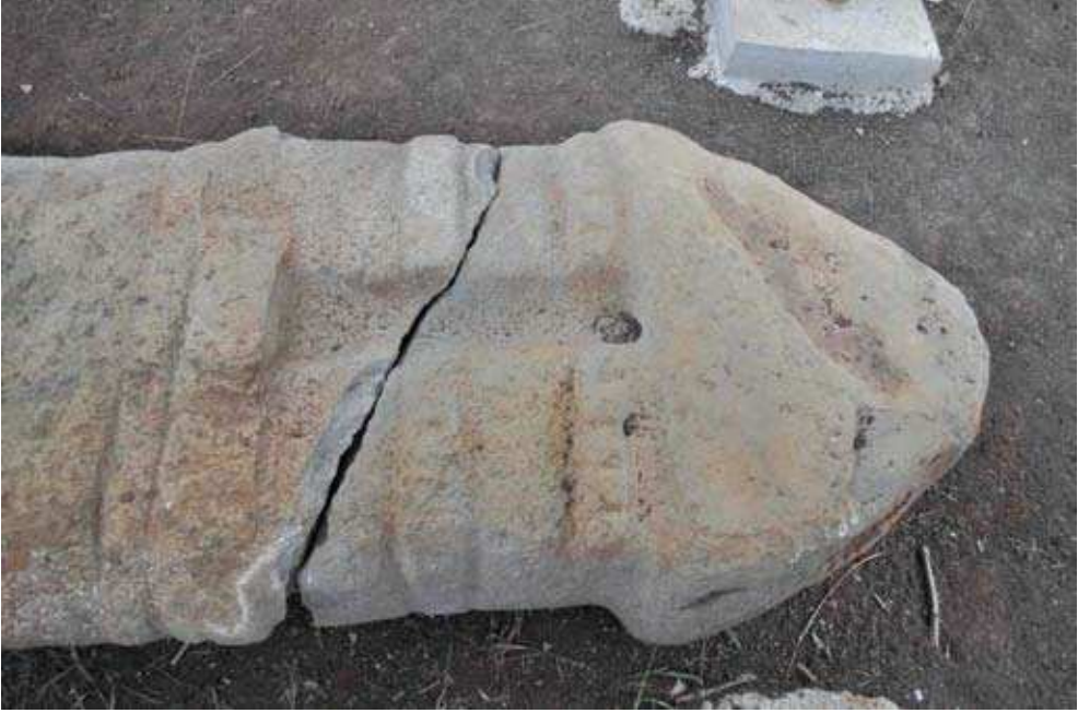
Şekil 3.2. Volkanik tuf taşından yapılmış bir monolitin taşınma sırasında düşmesi sonucunda oluşan kırılma (San Agustín, Kolombiya).
