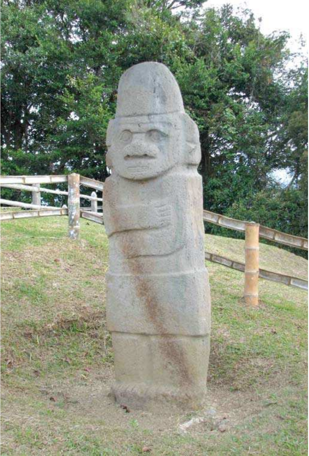
Şekil 3.47. Volkanik tüften yapılmış bir heykelin yüzeyinde yağmur sularının neden olduğu renk değişimi (San Agustín, Kolombiya).
