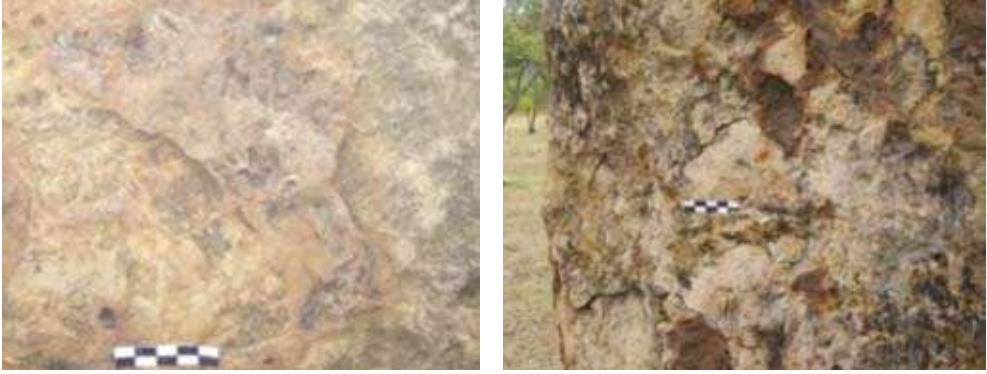
Şekil 3.11. Sıcaklık değişimleri ve kimyasal ayrışma olayları sonucunda kaya kütlelerinin ince tabakalar halinde taşın yüzeyine paralel levhalar halinde ayrışması (eksfolyasyon) olan dokuya bağlı çözünme.
