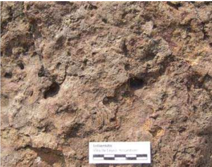
Şekil 3.21. Genellikle kumtaşlarında gözlenen çukurlaşma veya oyuklanma olarak tanımlanan bozunma.
