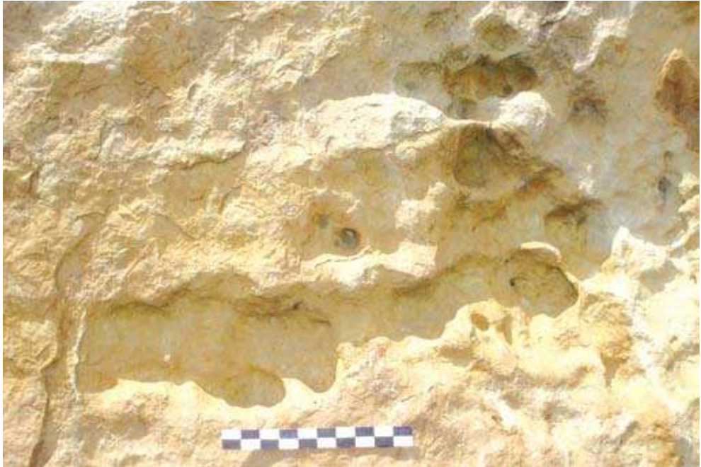
Şekil 3.22. Kumtaşında görülen mağaracık şeklindeki bozunma.
