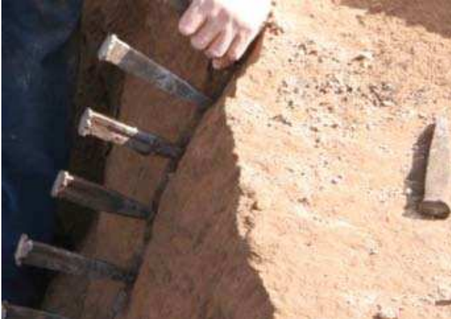
Şekil 2.15. Bitlis'in Ahlat ilçesindeki taş ustalarının taşları ocaktan halen geleneksel tekniklerle keski ve murç kullanarak çıkartmaları. Karatepe Açık Hava Müzesindeki geç Hitit çağı kalesinin duvar restorasyonunda Kahramanmaraş'ta hâlâ eski geleneksel usullerle çalışan taş ustalarından yararlanılmıştır (sağda).
